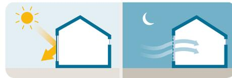
Die sommerliche Hitze wird abgeblockt. Die thermische Trägheit des Gebäudes wird genutzt, um die Kühle im Inneren zu erhalten.
