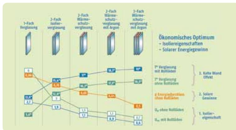
Fenster-Temperatur gemessen bei einer Außentemperatur bei 0°C und einer Innentemperatur von 20°C
