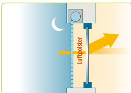
Rollläden verfügen über thermische Fähigkeiten, welche die grundlegenden Eigenschaften des Fensters ergänzen. Die thermische Leistung der Rollläden steigt, wenn durch Form, Material und Installationsweise eine möglichst vollständige Luftdichtigkeit erreicht wird.
