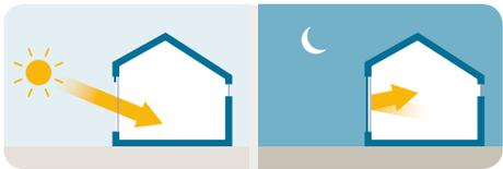
Nachts schließt der Rollladen zur Vermeidung von Energieverlusten durch die Fenster. Tagsüber sind die Rollläden geöffnet, um die kostenlose Sonnenenergie zu nutzen.
